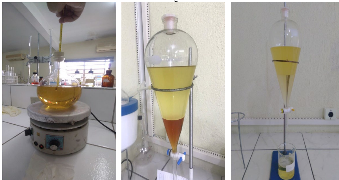
Figura 1: Processo de produção do biodiesel etílico de óleo de soja residual: (a) síntese; (b) decantação; (c) lavagem.
