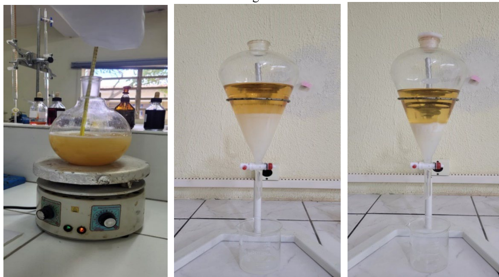
Figura 2. Processo de produção do biodiesel etílico de óleo de soja comercial: (a) síntese; (b) decantação; (c) lavagem.
