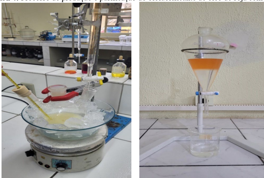
Figura 4: Processo de produção e purificação do biolubrificante de óleo de soja comercial.
