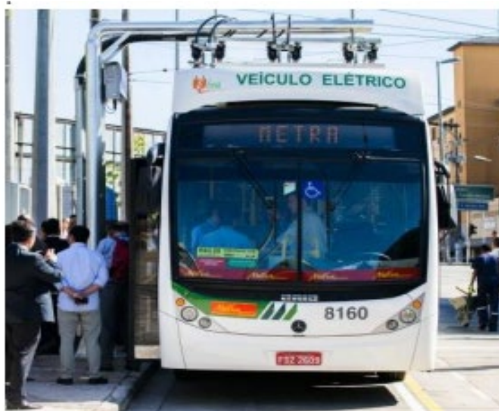
Figura 2: Sistema de recarga rápida de ônibus elétrico, modelo Fabricado pela Ellectra Bus LTDA.
