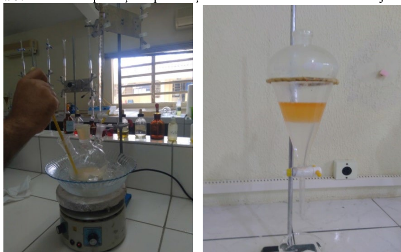
Figura 3: Processo de produção e purificação do biolubrificante de óleo de soja residual.
